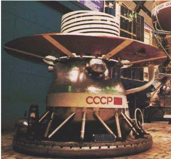
Landekapsel Venera 13 (Sowjetunion, 1982); sendete nach der Landung noch gut 2 Stunden
