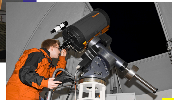
Bild rechts: Teleskop (35cm Öffnung) mit seiner stabilen Montierung
